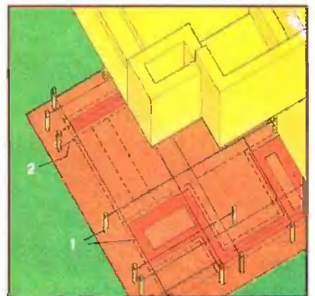
Рис. 3. Обноску следует возводить аккуратно. Неточность скажется на последующих стадиях работы: 1 — колья забивают за пределами зоны выемки грунта; 2 — все шнуры должны располагаться на одном уровне и под прямым углом по отношению друг к другу
